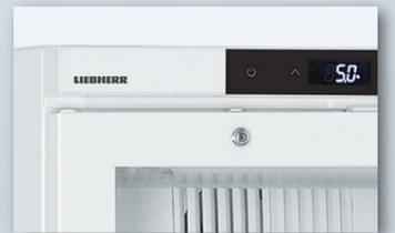
Die präzise Elektronik mit digitaler Temperaturanzeige erlaubt eine genaue Temperatureinstellung. Ein integrierter Datenspeicher dokumentiert die jeweils letzten drei Temperaturalarm- und Netzausfallereignisse mit Datum, Uhrzeit und Dauer des Alarms. Die entsprechenden Daten können über die AlarmLog-Funktion abgerufen und auf dem Displayfeld abgelesen werden.
