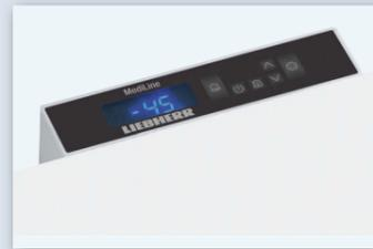
Optischer und akustischer Temperaturalarm warnen bei Überschreitung der **Temperaturabweichungsgrenzen**. Die Alarmparameter für den Temperaturalarm können individuell eingestellt werden. Der in die Elektronik integrierte Datenspeicher
