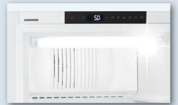
Die flächenbündig integrierte Elektronik verfügt über einen **integrierten Datenspeicher**. Dieser dokumentiert unter anderem die maximal und minimal auftretenden Innenraumtemperaturen nach erstmaligem Erreichen der Soll-Temperatur, um eine einfache Dokumentation der Lagerbedingungen zu gewährleisten. Der Min/Max-Speicher kann bis zu 41 Tage die minimal und maximal aufgetretenen Innenraumtemperaturen anzeigen.
