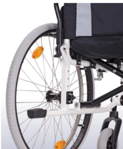
Über die Adapterplatte lassen sich bis zu vier Sitzhöhen am Antriebsrad anpassen und durch das Drehen der Platte eine Radstandsverlängerung um 7 cm einstellen. Dies ist besonders in Kombination mit elektrischen Zusatzantrieben von Vorteil.
