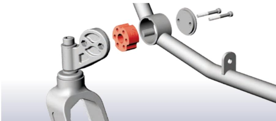
Die **Vorderradanbindung (Castor)** garantiert bei jeder Höhen- und Winkeleinstellung eine extrem hohe Stabilität durch die formschlüssige Verbindung der einzelnen Komponenten.
