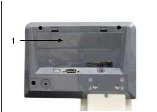
Akkufachdeckel (1) an der Unterseite des Anzeigegerätes öffnen und Akku anschließen. Der Akku sollte vor der ersten Benutzung mindestens 12 Stunden geladen werden.
